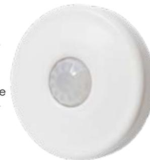
E' anche dotato di  **sensore triassiale con tecnologia MEMS**, che rivela spostamenti di circa 20° rispetto alla posizione iniziale di apprendimento. **(Solo su Moon360)**. L'altezza massima di installazione è di 4m mentre la minima è di 1,8m. La massima apertura è di Ø 10m mentre la minima è di Ø 4,4m.
