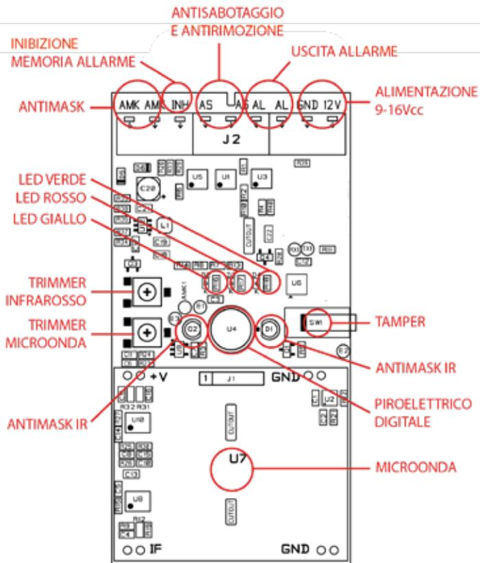
**ATTENZIONE:** Quando il sensore va in inibizione la MW viene spenta.
