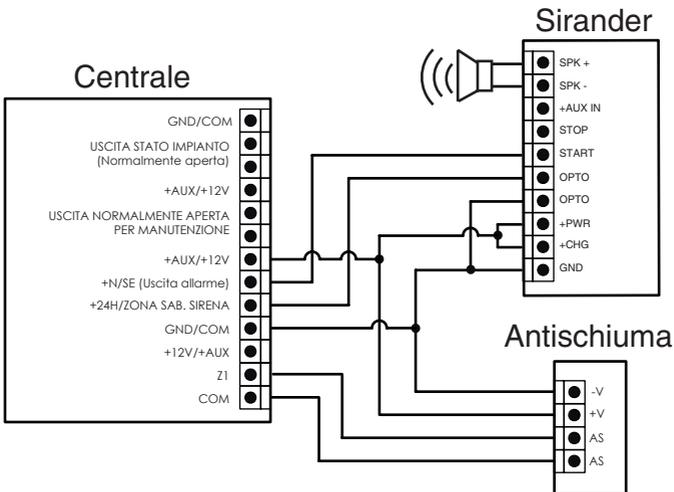
**SIRANDER (cod. 900124) COLLEGAMENTO CON USCITA ALLARME ANTISCHIUMA IN SERIE ALL'ALLARME TAMPER**
